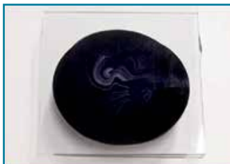
Figura 1: Marble test con esito negativo per miscelazione non omogenea
